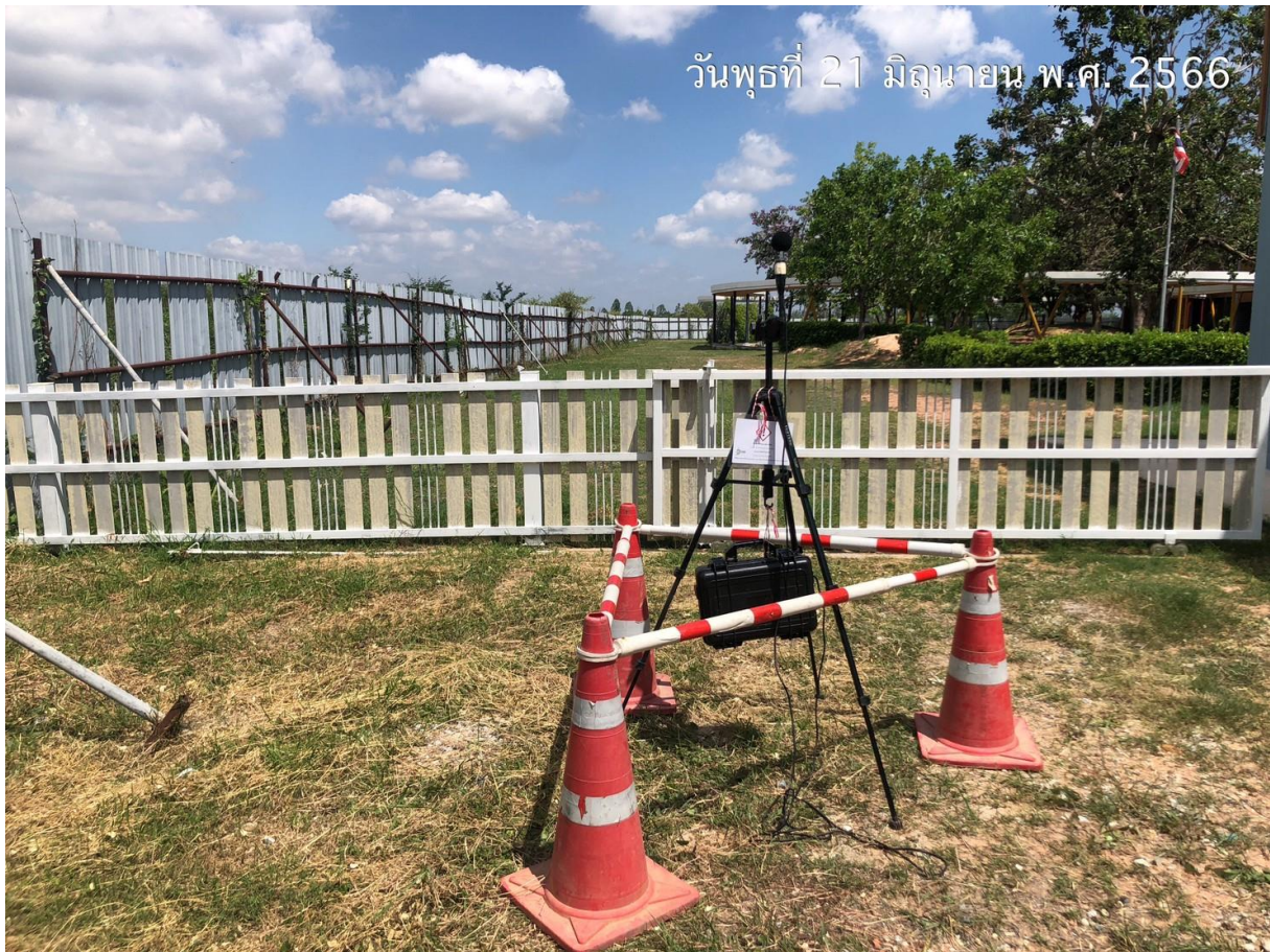
รูปที่ 3.2.2-1 การติดตั้งเครื่องมือตรวจวัดเสียง
